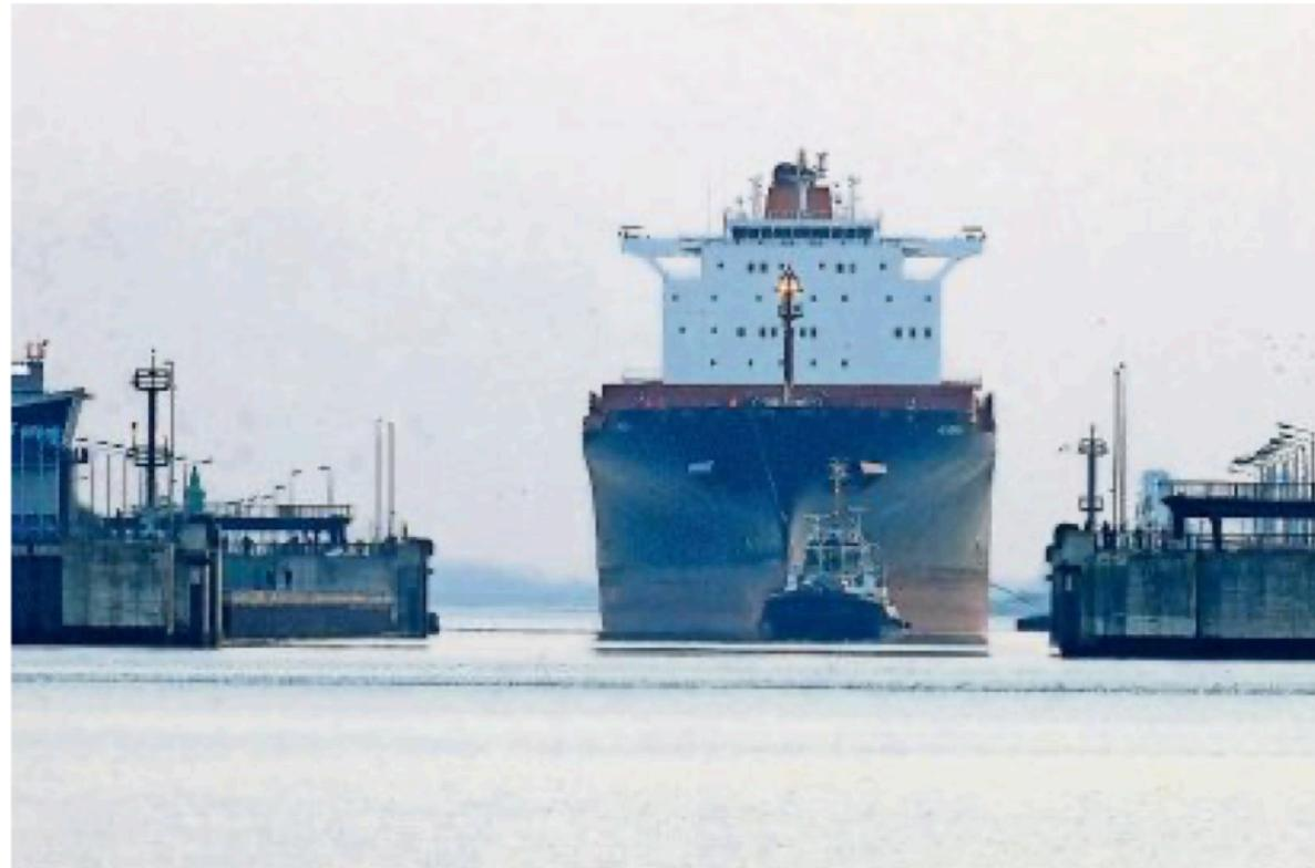
**Weil die „Al Kharj“ länger als die Kaiserschleuse ist, passierte das Containerschiff bei zeitgleich geöffnetem Außen- und Binnenhaupt mit einer sogenannten Dockschleusung. Für Reparaturarbeiten liegt das Schiff jetzt an der Westkaje und wird in 14 Tagen wieder auslaufen.** Foto: Eckardt
